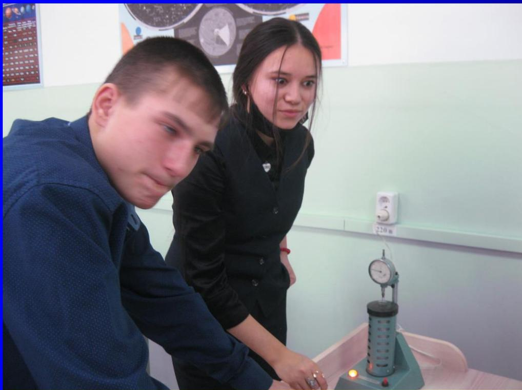
Исследование расширения твёрдых тел при нагревании
